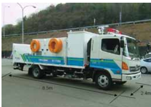
排水ポンプ車
