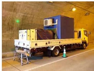
トンネル点検(レーザー打音)
