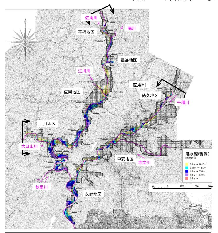
河川改修前(平成 21 年 8 月 9 日) 580ha,859 戸 (シミュレーションによる実績洪水の再現結果)
