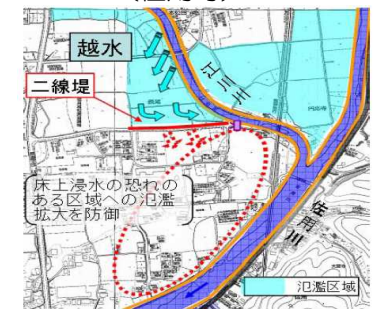
図③ 二線堤位置図(佐用川)
