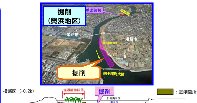
掘削による対策
