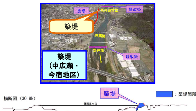
築堤による対策
