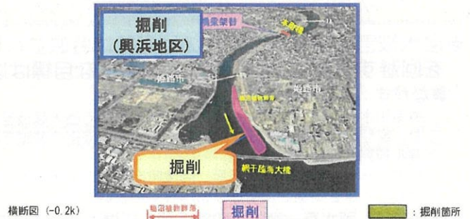
掘削による対策の一例
