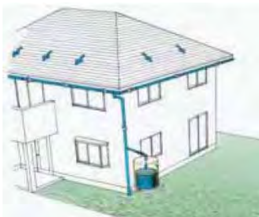
図 5-12 各戸貯留施設の例(地上タイプ)
