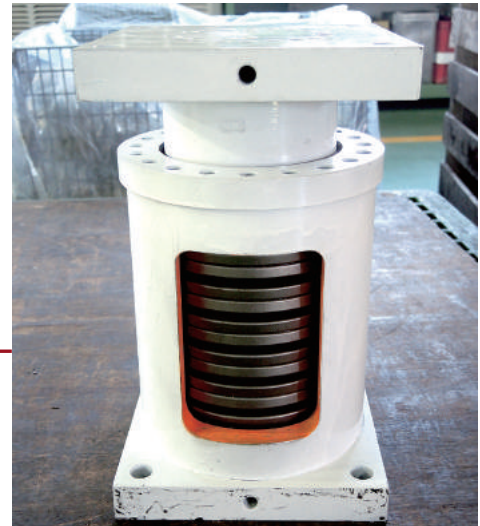
皿ばねユニットの性能を調べる検査機
