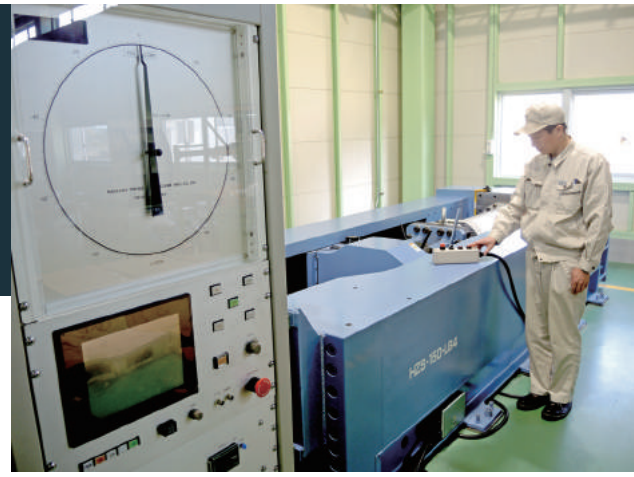
皿ばねユニットの性能を調べる検査機
