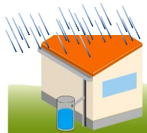
屋根に降った雨水を貯留
