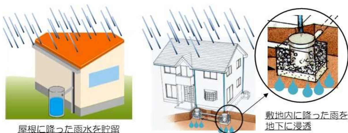
雨水貯留・浸透（各戸）
