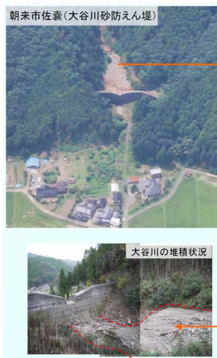
図 5.6.8 朝来市の大谷川砂防堰堤による土砂の捕捉状況（2009（平成21）年8月豪雨時）
