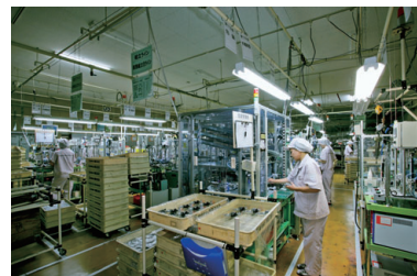
ガスコンロ用バルブ組立ライン風景
