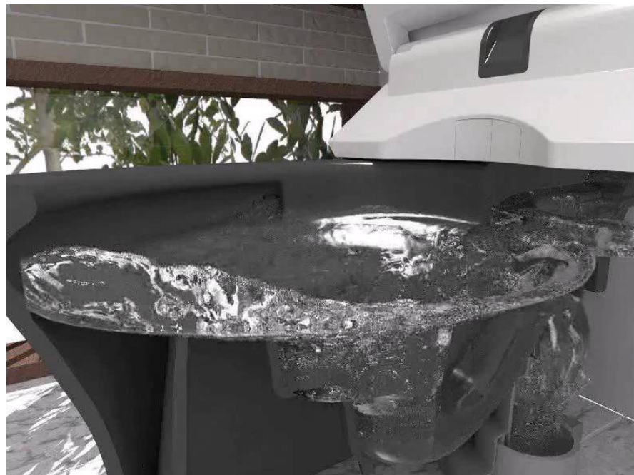
東工大スパコン「TSUBAME」 衛生陶器シミュレーション結果 (メッシュ間隔 0.5mm )
