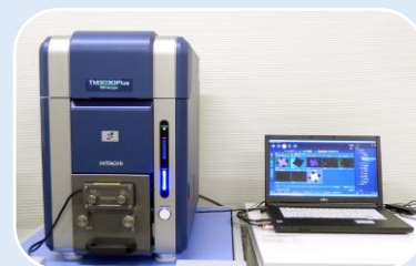
X線分析装置付走査型電子顕微鏡 日立ハイテクノロジー社製 TM3030Plus
