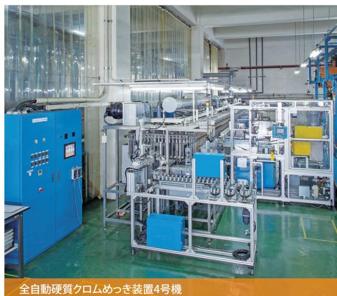
全自動硬質クロムめっき装置4号機
