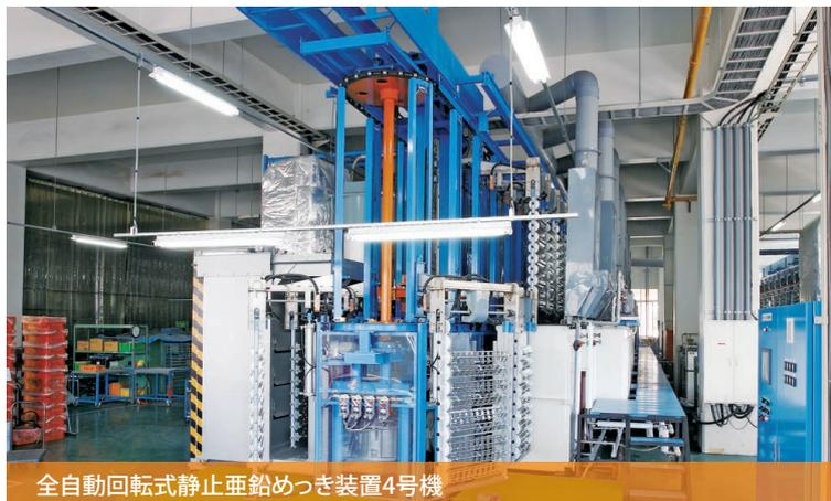
全自動回転式静止亜鉛めっき装置4号機
