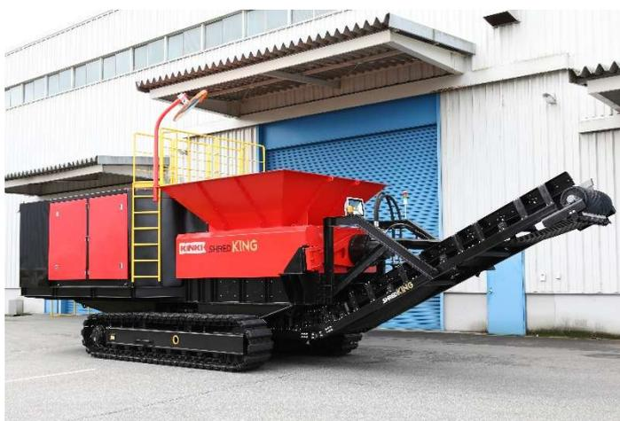
自走式二軸剪断式破砕機「シュレッドクローラー」
