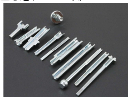
写真：冷間鍛造による一次加工品の切断サンプル(鍍金処理後) サンプルを縦に切断している。
