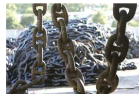
写真：アンカーチェーン
