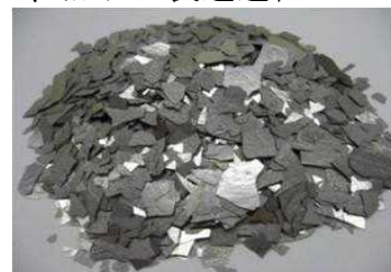
写真：ストリップキャスト法で製造したネオジム鉄ボロン磁石合金鑄片
