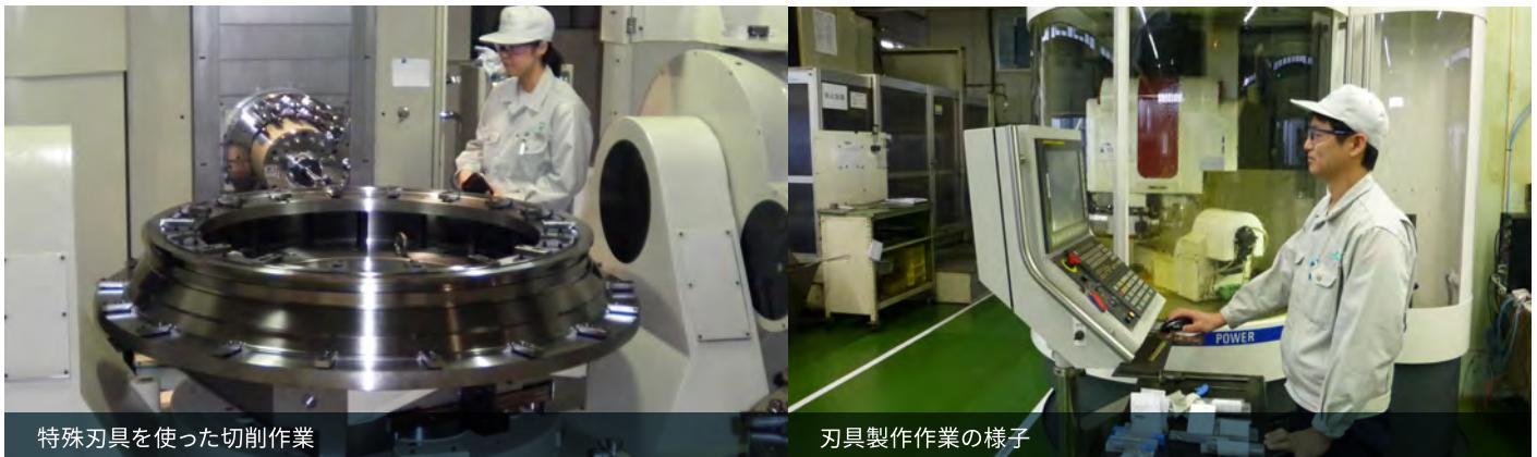
航空機部品の品質の決め手となるのは、使用する工作機械の性能・機能と、「職人技」と呼ばれる技術者の技能との組合せです。特にミツ精機株式会社が手がける航空機部品は難削材であるため、加工する際、ワーク(加工対象物)には圧力や加工熱がかかり、ひずみ、膨張、収縮などが起こります。それ以外にも材料のロットの違いによる影響もあり、加工は常に「一期一会」です。したがって、高性能・高機能の工作機械を保有とともに、すぐれた技と感覚を持った職人が必要になります。このような工作機械
