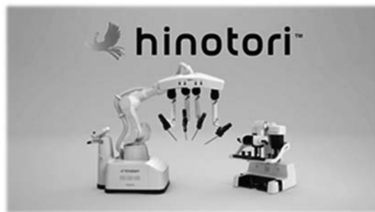
(日本発の手術支援ロボット「hinotori™ サージカルロボットシステム」)
