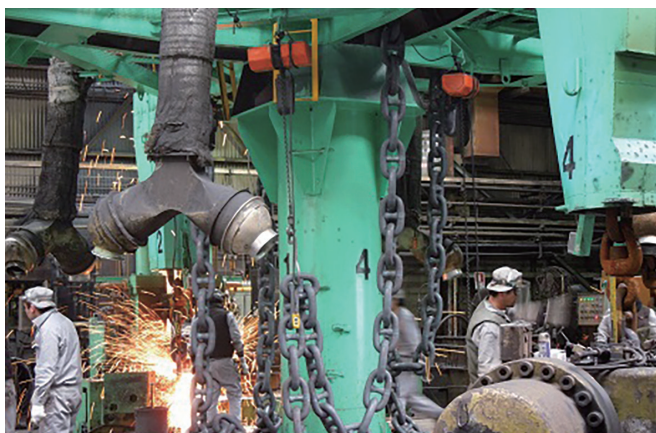
大型チェーンの製造風景 左奥で火花を上げているのがフラッシュバット溶接機です
