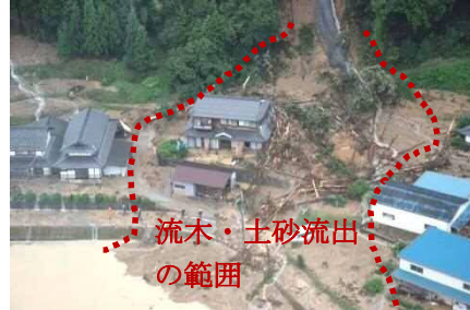
流木と土砂による家屋の被害状況 (丹波市市島町上竹田)
