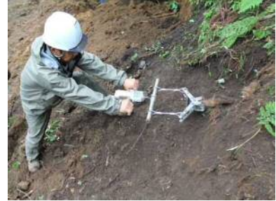
根の引き抜き試験
