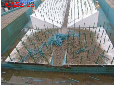
災害緩衝林と簡易流木止め施設による流木・土砂捕捉状況（流木長 4m、溪岸高 0.99m）
