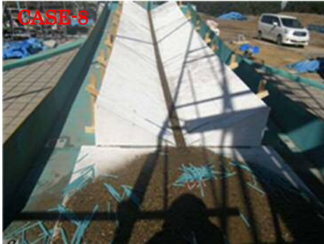
従来型の簡易流木止め施設での流木捕捉状況 (流木長 4m、設置位置：勾配 2° 区間)
