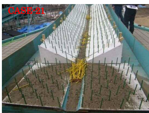
災害緩衝林と簡易流木止め施設による流木・土砂捕捉状況 (流木長 7m、溪岸高 0.99m)
