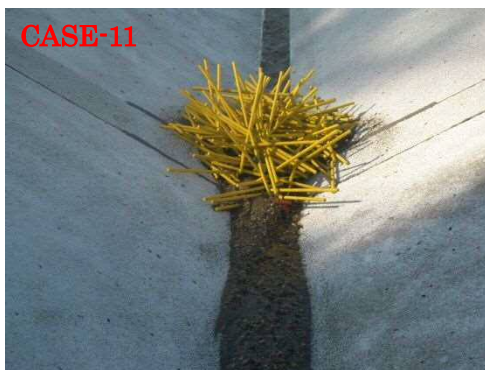
従来型 V字谷での流木捕捉状況 (流木長 7m、設置位置：勾配 6° ~10° 区間)
