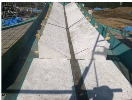
災害緩衝林が無い実験水路
