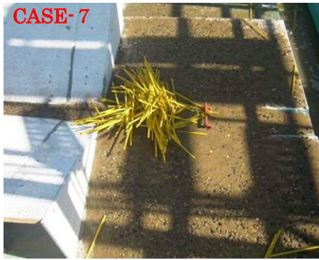
従来型の簡易流木止め施設での捕捉状況 (流木長 7m、設置位置：勾配 2° 区間)
