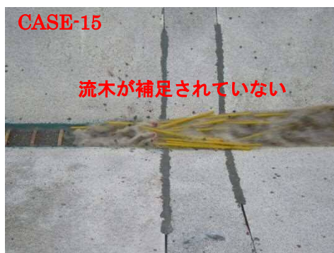
改良I型での捕捉状況 (流木長 7m、設置位置：6° と 10° の変化点)
