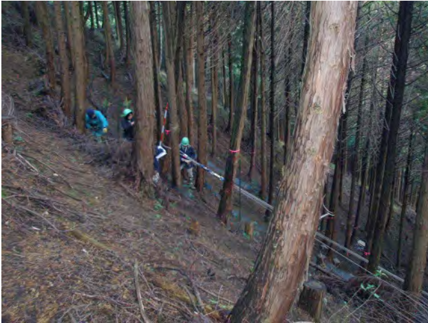
〔写真3-2〕 立木の引き倒し抵抗カの測定（左／ヒノキ【緊9】、右／コナラ【混11】）
