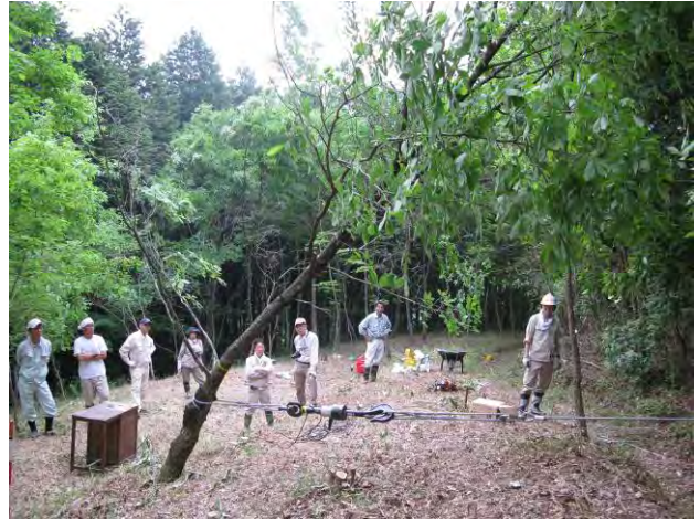
〔写真3-2〕 立木の引き倒し抵抗カの測定（左／ヒノキ【緊9】、右／コナラ【混11】）
