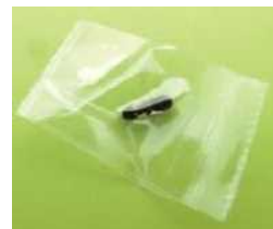
セロテープで周囲を囲むように接着する 出典：ストップ・ザ・ヒアリ
