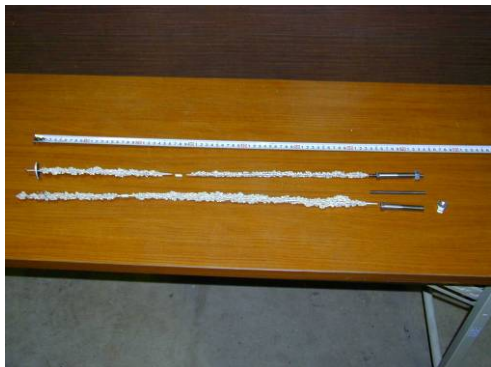
写真 5 ロックボルト+支圧板
