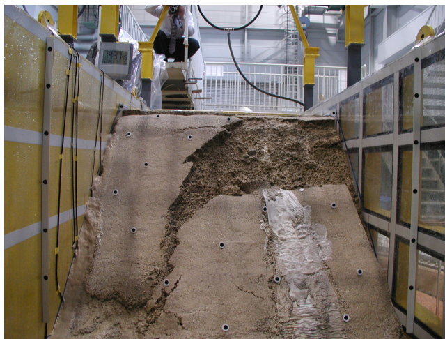
(a) 無対策斜面の崩壊（平成 14 年度 CASE5：降雨開始 64 分後）
