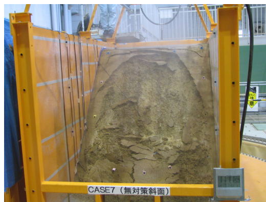
(a) 無対策斜面の崩壊（平成 17 年度 CASE7：降雨開始 28 分後）
