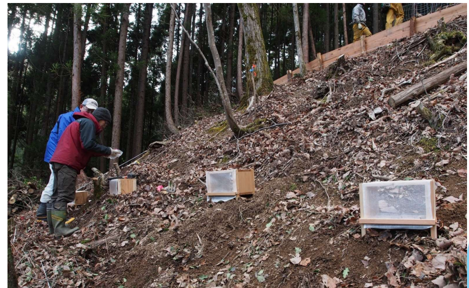
写真 土砂受け箱の設置状況 (試験区下に土砂受け箱を設置し、 定期的に土砂回収)
