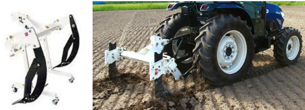
2連サブソイラーと作業状況
