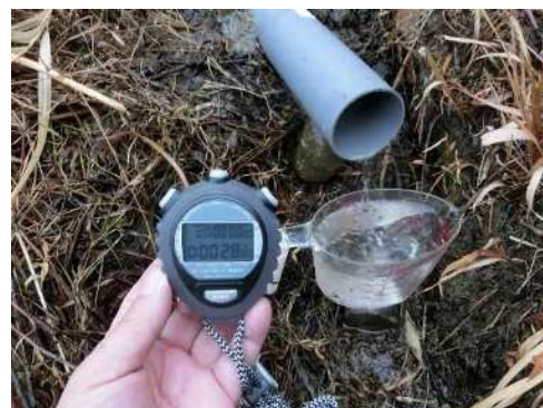
後法 漏水量測定(近景)
