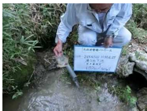
後法 漏水量測定(遠景)
