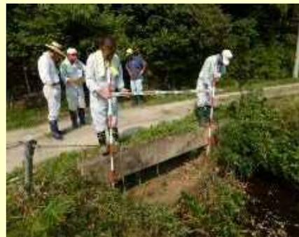
洪水吐断面の測定
