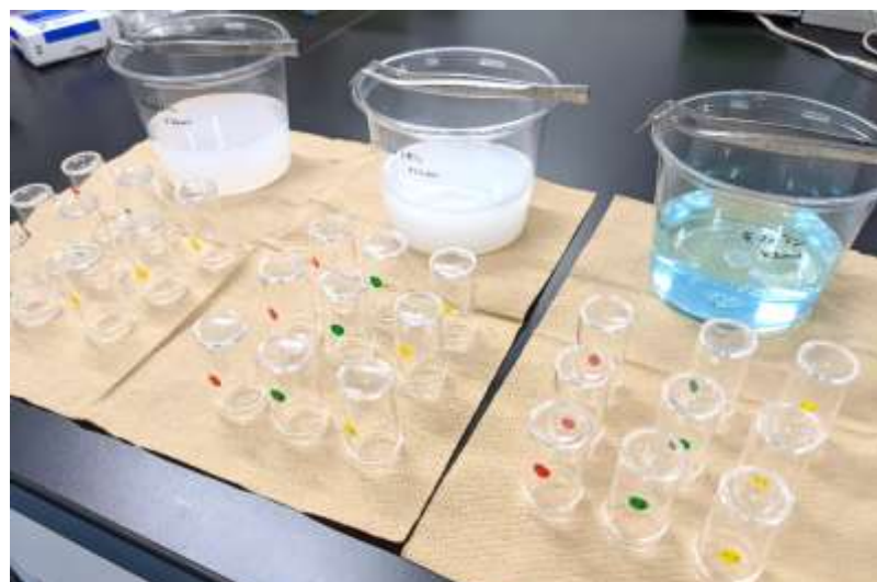
スチロール棒瓶の内部を薬液で満たし、風乾
