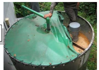
反応槽 (間伐材チップ充填機)
