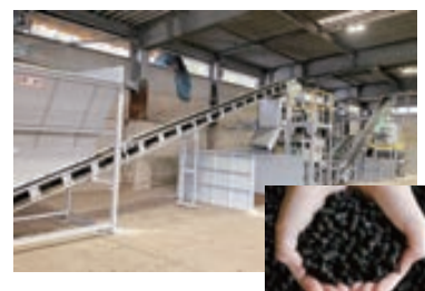
牛ふん堆肥等を原料としたペレット肥料の製造施設（神戸市）
