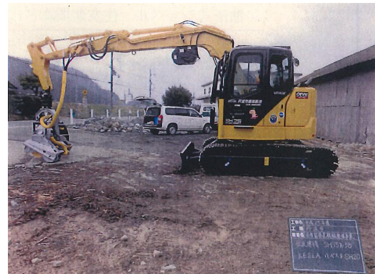
高性能林業機械(油圧式ショベル)
