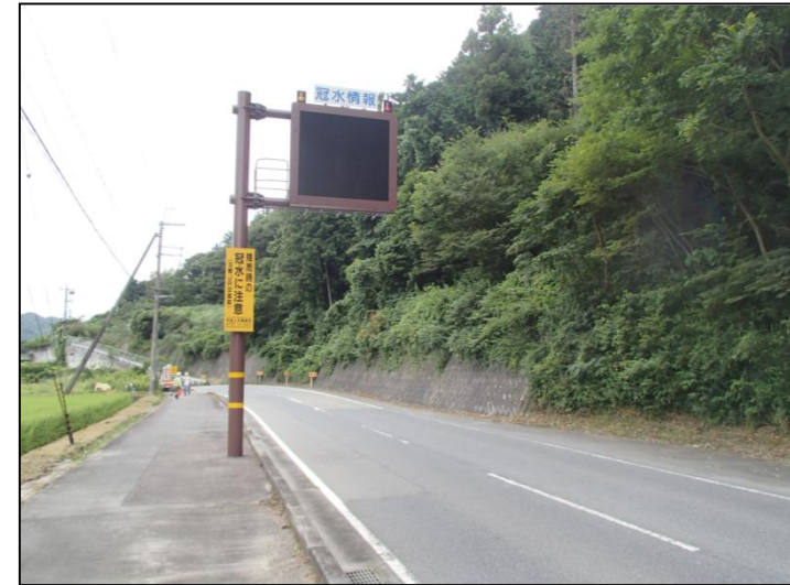
道路アンダーパスの冠水情報板 [丹波市山南町]
