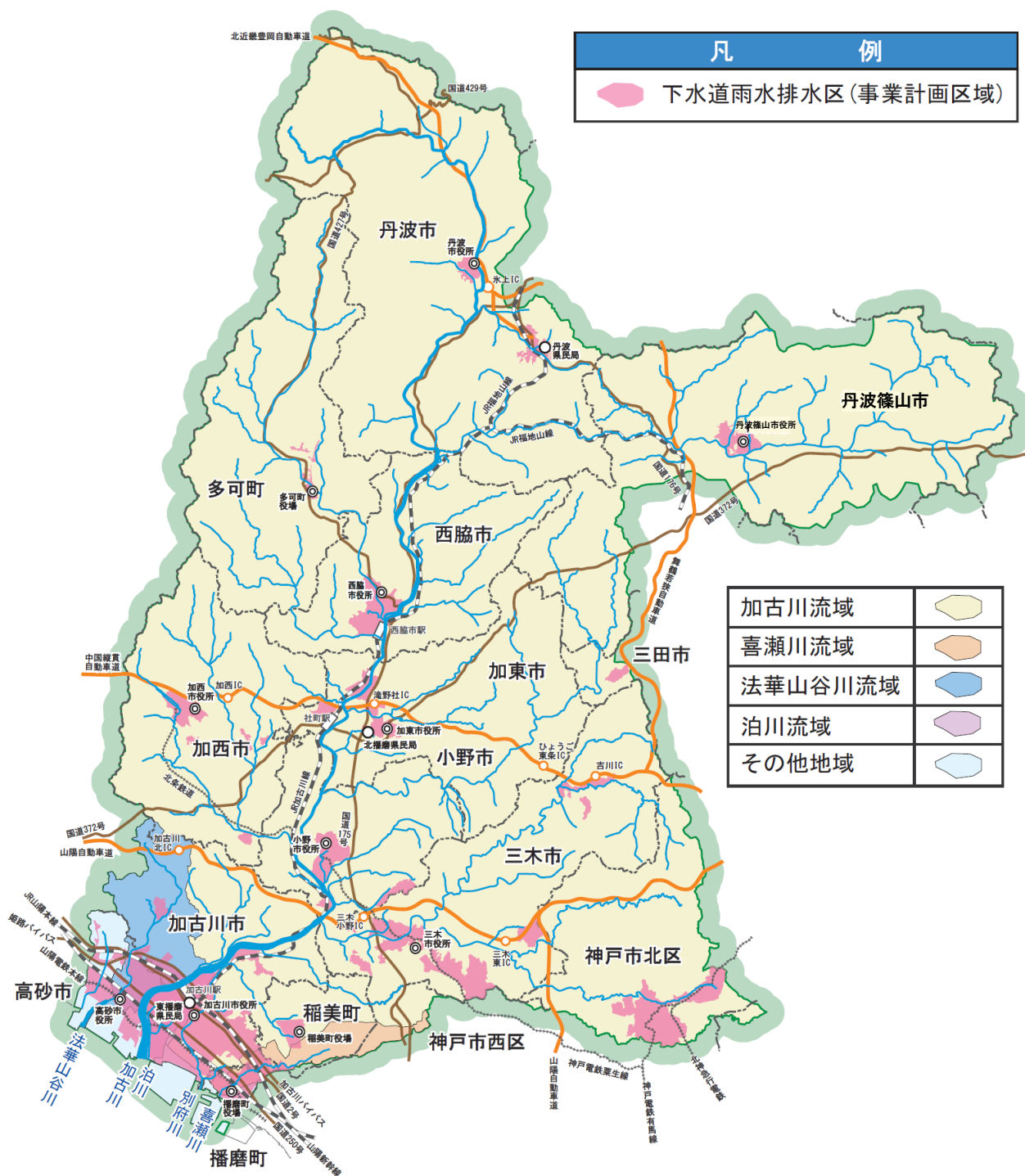
図 35 下水道の雨水排水区
