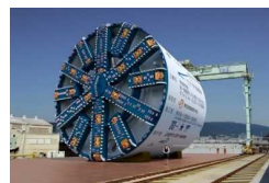
日進月歩のトンネル掘削技術（シールド工法）
