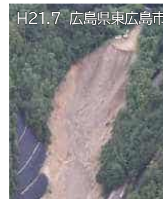
廃棄された土砂の崩落 死者1名、重傷者1名 住宅被害1棟
