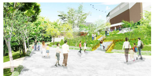
透水性舗装やバイオスウェルを採用し、雨水浸透機能を確保するとともに、レインガーデンを取り入れたランドスケープデザイン(南町田グランベリーパーク、町田市)
