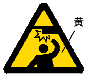
天井に注意 Caution, overhead
