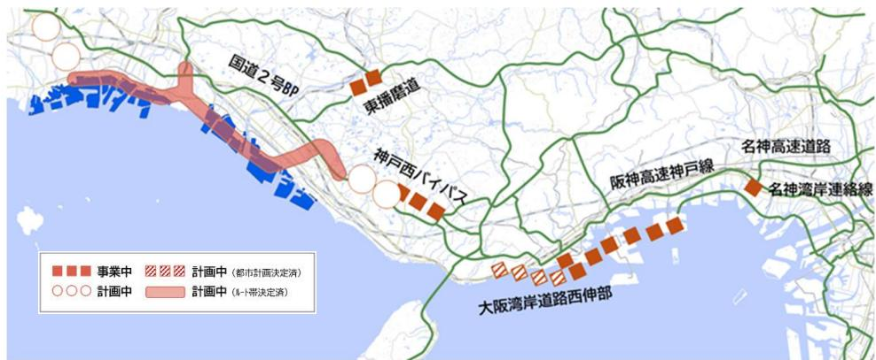
図 2-4：播磨～大阪への高規格道路の整備状況
