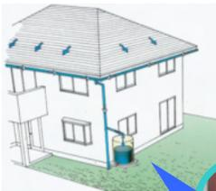
屋根に降った雨水をタンクに貯めて、敷地の外に流れ出る雨水の量を減らします。タンクに貯めた水は、庭の水やり等に使えるので、節水にも役立ちます。
