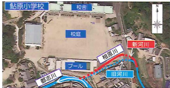
点線：隧道（トンネル） 実線：開水路
