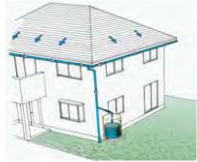
画) 各戸貯留(タンク設置)の事例
