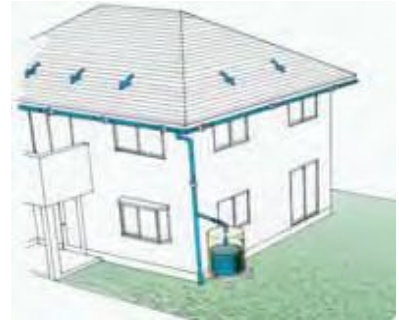
画) 各戸貯留(タンク設置)の事例
