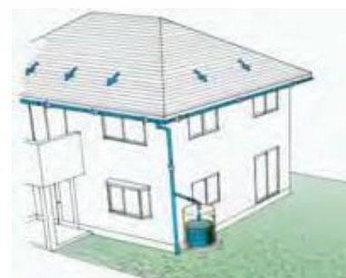
画) 各戸貯留（タンク設置）の事例
