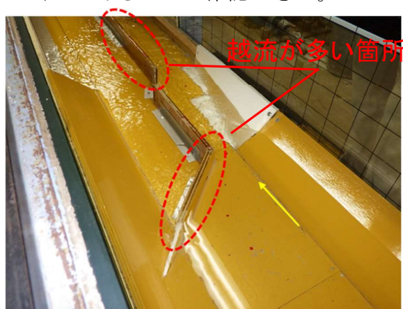
写真-4.1 水理模型実験 ( Q=16.0\text{ m}^3/\text{s} : ピーク時)
