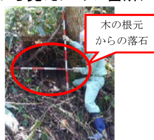
木の根元からの落石事故（H28.5 出典：島根県ホームページ）
