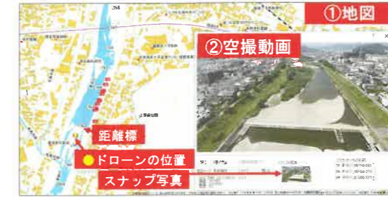
ドローンで撮影した動画をGIS上のシステムで閲覧し、河川堤防等を点検・監視
