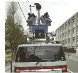
MMS(モバイル・マッピング・システム)による、道路施設の点検
