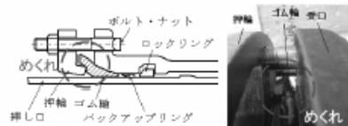
図 接合不良の例
