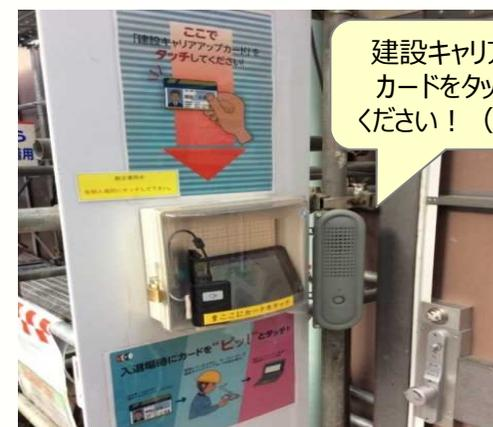
人感センサーによる技能者への自動音声呼びかけ
