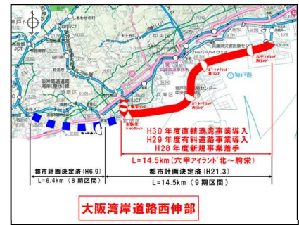
大阪湾岸道路西伸部の整備状況
